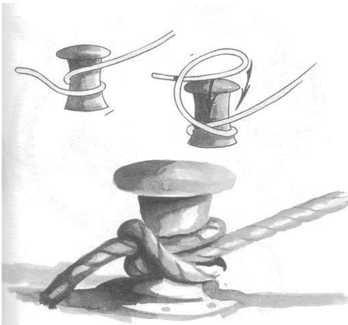
Figuur 47: vastleggen aan bolder 2 e manier.
