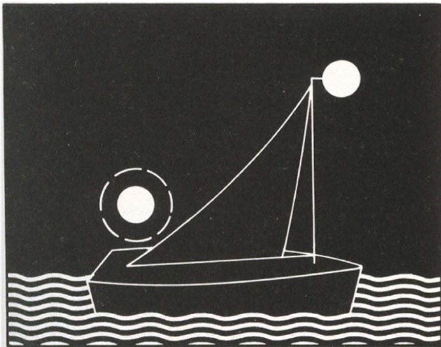
Artikel 3.13, lid 5: Klein zeilschip waarbij de boordlichten en het heklicht in één lantaarn aan de top van de mast verenigd zijn.
